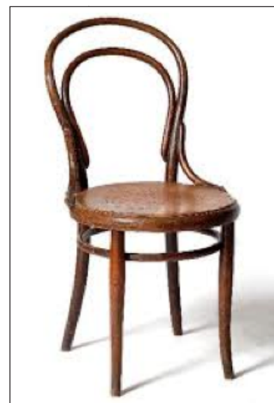
"Wienerstol", stol af dampbøjet, opr. lamineret træ, udviklet fra ca. 1840 i Wien af Michael Thonet. Der findes flere typer af denne lette stol med de svungne linjer, fx Thonetfabrikkens nr. 14, kaldet wiener-caféstolen, med sæde af rørflet eller krydsfinér, der fra 1859 blev masseproduceret til bl.a. caféer og restauranter i Europa og USA.
